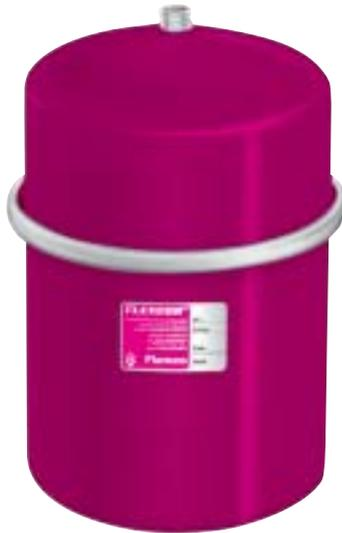
Les vases d'expansion Flexcon sont des vases en acier laqué électrolytiquement qui renferment une membrane maintenue par un anneau de serrage. Le volume situé sous la membrane est rempli d'azote. Du fait de la compressibilité du coussin d'azote, le volume ainsi créé permet de recueillir de l'eau en provenance de l'installation de chauffage central.
